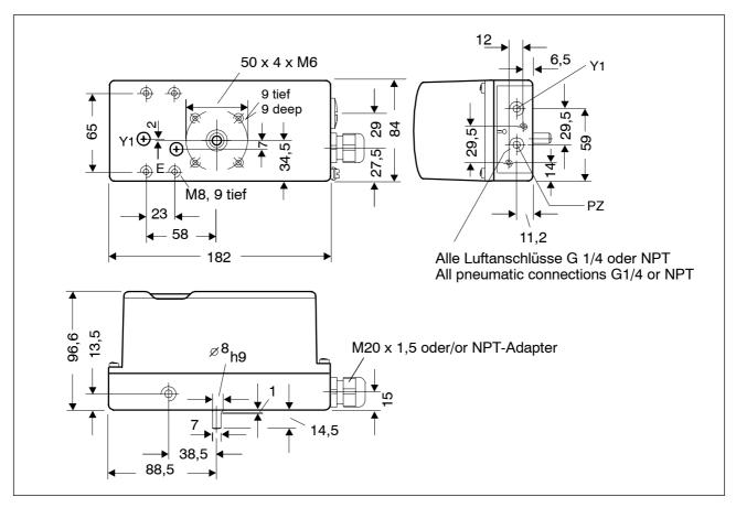
Bild 25 Maßbild Ausführung Metallgehäuse
