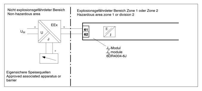
Bild 17  $J_y$ -Modul, EEx i, EEx n Fig. 17  $J_v$  module, EEx i, EEx n
