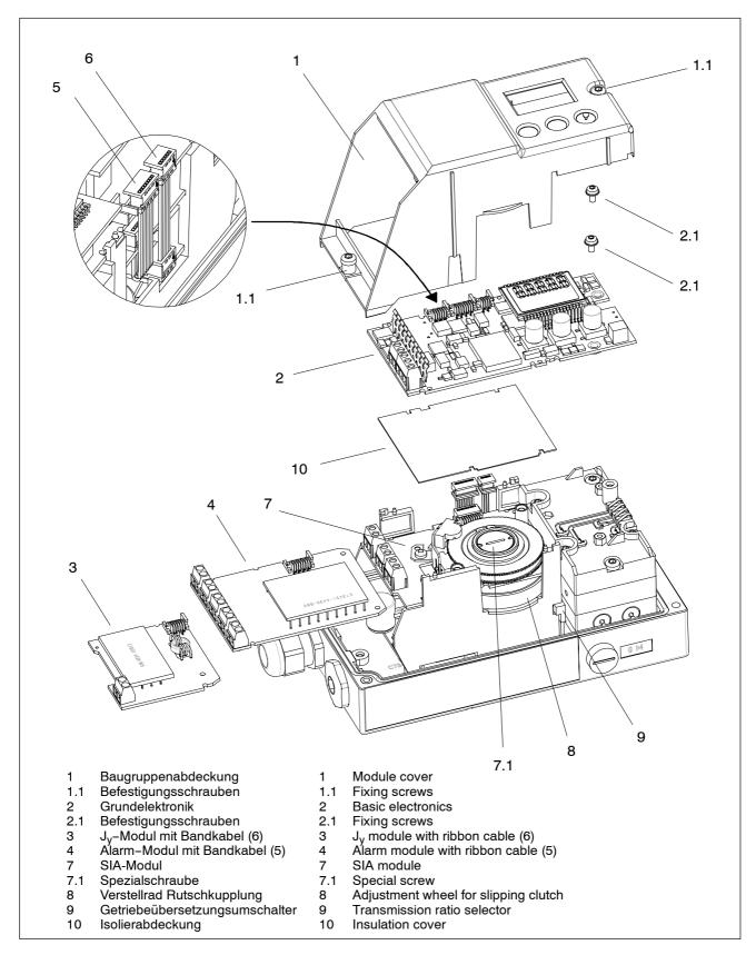
Bild 9 Einbau der Optionsmodule Fig. 9 Installation of options
