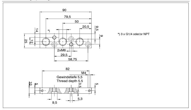
Bild 24 Maßbild Anschlussleiste für Kunststoffgehäuse
