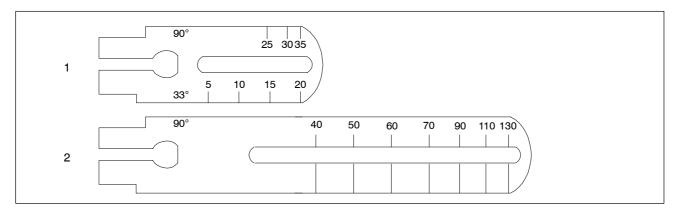
Bild 22 Hebel NAMUR 3 mm bis 35 mm (1), Hebel NAMUR > 35 mm bis 130 mm (2)
