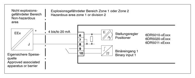
Bild 11 2-Leiteranschluss, EEx i, EEx n
