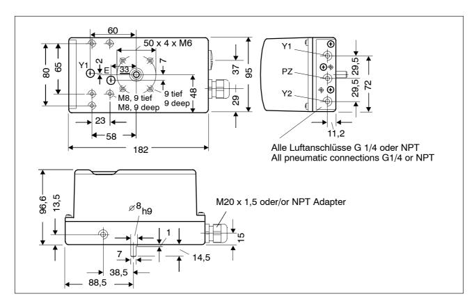
Bild 23 Maßbild Ausführung Kunststoffgehäuse
